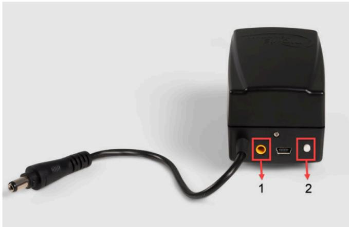
Un botón conectado a la conexión de toma tiene la misma funcionalidad que el pulsador integrado.
