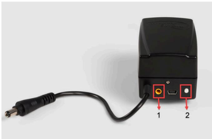
Eine an die Klinkenbuchse angeschlossene Taste bietet die gleiche Funktionalität wie die geräteeigene Drucktaste.
